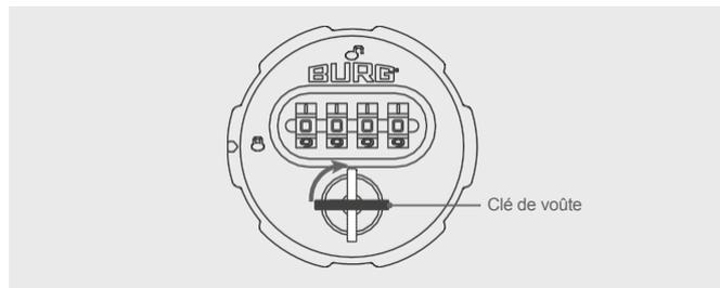
2. Pendant que la clé reste dans cette position, tournez avec précaution chaque roue numérotée individuellement de haut en bas jusqu'à ce qu'elle s'arrête, en commençant par la roue numérotée gauche. Veillez à ne pas passer à la roue numérotée suivante tant que la roue numérotée précédente ne s'est pas arrêtée à la bonne position. Lorsque toutes les roues numériques sont dans la bonne position, vous pouvez
