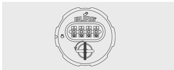
4. Tourner le bouton de 90 degrés vers la droite jusqu'à ce que l'indicateur d'état pointe sur le symbole de la serrure ouverte. La serrure est maintenant ouverte.
