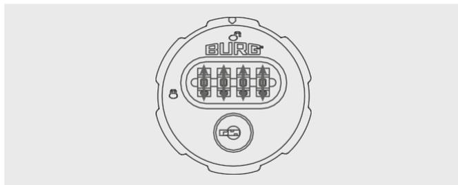
2. Tourner le bouton de 90 degrés vers la droite jusqu'à ce que l'indicateur d'état pointe vers le symbole de la serrure ouverte.
