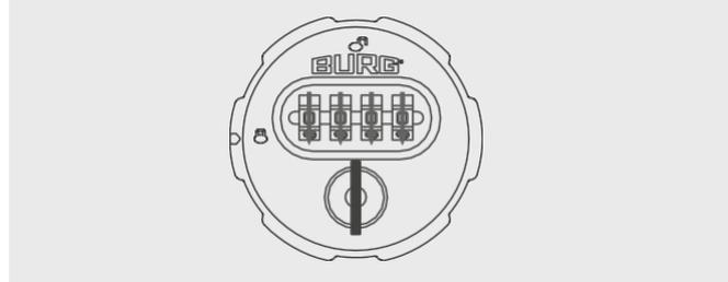
3. Tourner la clé de 90 degrés vers la gauche et la retirer.
