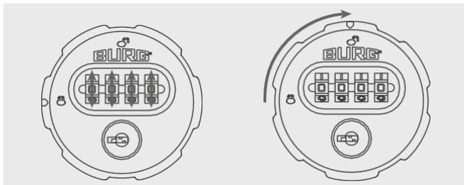
2. Lorsqu'il est ouvert, réglez votre code préféré en plaçant les roues numérotées dans la position appropriée. Orientez-vous sur la ligne de guidage. Lorsque la serrure est verrouillée (tourner dans le sens inverse des aiguilles d'une montre et ajuster les roues numérotées), ce code est valide.
